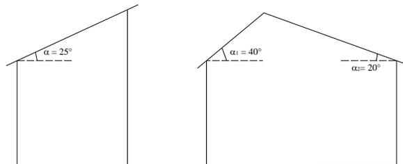
11. Si consideri un capannone industriale situato nella provincia di Firenze, in area suburbana, ad un'altitudine di  $500$  metri sul livello del mare. Con riferimento alle dimensioni e allo schema statico in figura (interasse:  $i=5\text{m}$ ), determinare:
