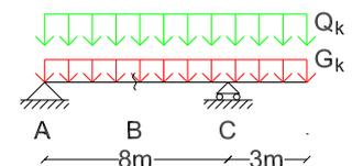
6. Nel seguente schema, determinare il valore di calcolo del massimo momento flettente positivo in mezzera per verifica allo stato limite ultimo.
