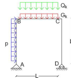
5. Determinare la massima sollecitazione (momento flettente) di progetto nelle sezioni B (sezione in campata di momento massimo) e C (sezione di appoggio) della trave in figura, per effetto delle seguenti azioni:
